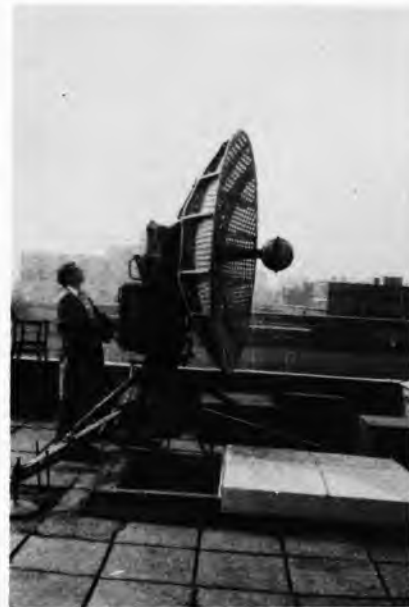
Sl. 28. Elektronski teodolit GMD-1A
