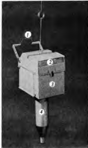
Sl. 26. Američka radio-sonda, tip 1190. 1 senzor za temperaturu, 2 senzor za vlagu, 3 spremište za bateriju, 4 radio-davač
