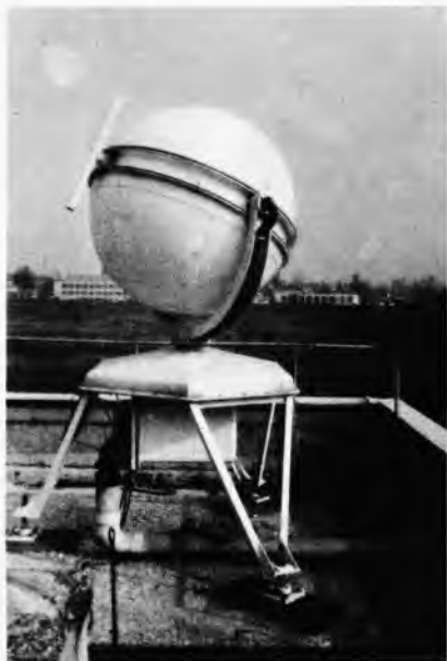
Sl. 29. Radar za mjerenje visinskog vjetra (Plessey WF3)
