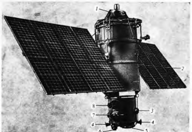
Sl. 33. Meteorološki satelit KOSMOS-144. 1 mehanizam za orijentaciju sunčanih baterija, 2 ploče sunčanih baterija, 3 uređaj za kontrolu orbite, 4 antene, 5 televizijske kamere, 6 magnetni davač, 7 aktinometrijski uređaj, 8 prijamnik infracrvenog zračenja
