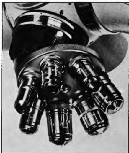
Sl. 15. Revolver s objektivima. Na njemu se nalazi niz objektiva različitih svojstava koji se u toku mikroskopiranja mogu mijenjati zakretanjem revolvera
