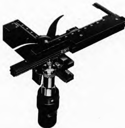
Sl. 16. Koaksijalni manipulatori na mehaničkom stolu. Pomoću zupčastog sustava stol se pomiče u dva međusobno okomita smjera u ravni stola. Namještanje se kontrolira skalom s nonijem
