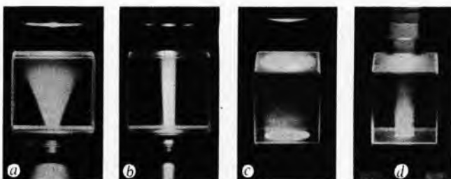
Sl. 20. Izgled svjetlosnog snopa pri izlasku iz uzorka. Mijenjanjem otvora aperturne dijafragme svjetlosni konus može imati: a veći kut za objektivne velike numeričke aperture (maksimalno otvorena aperturna dijafragma), b manji kut za objektivne male numeričke aperture (minimalno otvorena aperturna dijafragma). Mijenjanjem otvora dijafragme svijetlog polja promjer snopa može biti: c širok za slabe objektivne s velikim vidnim poljem (maksimalno otvorena dijafragma), d uzak za jake objektivne s malim vidnim poljem (minimalni otvor dijafragme)
