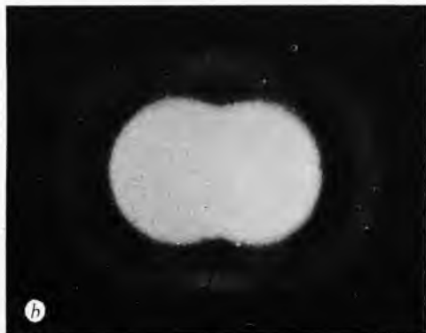
Sl. 7. Grafički prikaz Rayleighova kriterija za razlučivanje dvaju točkastih izvora (a) i slika dvaju točkastih izvora na Rayleighovoj granici razlučivanja (b)
