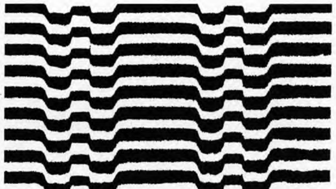
Sl. 54. Interferentna slika u monokromatskoj svjetlosti razlike razina debelih poluvodičkih elektroničkih filmova u integriranim sklopovima
