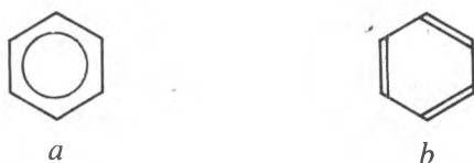
Sl. 17. Pretpostavljene strukture molekule benzena. a struktura s delokaliziranim elektronima \pi , b jedna od Kekuléovih struktura
