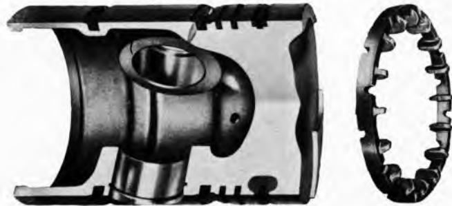
Sl. 81. Klip od aluminijskih legura s ulivenim nosačem prvog kompresijskog prstena
