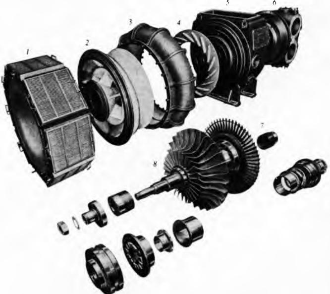
Sl. 104. Rastavljeno turbopuhalo. 1 usisni filter, 2 kućište rotora centrifugalnog puhalo, 3 spirala oko difuzora, 4 difuzor oko rotora, 5 kućište plinske turbine, 6 ulazno kućište plinova iz 2 x 3 cilindra (v. sl. 62) u plinsku turbinu, 7 plinska turbinu, 8 rotor puhalo
