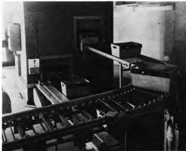
Sl. 57. Transport grada sustavom kontejnera na pokretnim trakama i paternoster-dizalima
