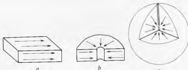
Sl. 44. Idealizirani modeli protjecanja fluida kroz naftonosni sloj pri crpljenju. a linearno, b radijalno, c sferično protjecanje
