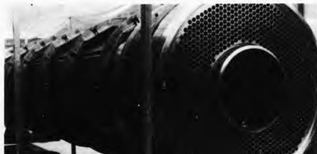
Sl. 53. Cijevni snop izmjenjivača topline natrij-natrij u nuklearnoj elektrani SNR-300
