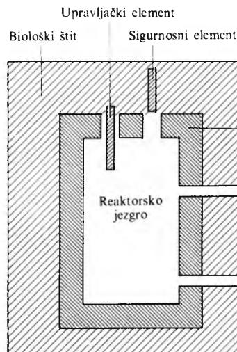
Sl. 1. Shematski prikaz fisionog nuklearnog reaktora
