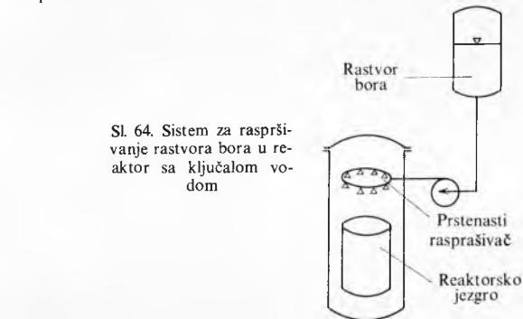
Sl. 64. Sistem za raspršivanje rastvora bora u reaktor sa ključalom vodom
