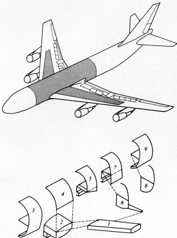
Sl. 4. Zrakoplov Boeing 747 rastavljen na superelemente. Dio konstrukcije koji je proračunavan (osjenčana ploha) rastavljen je na 9 superelemenata. Svaki od superelemenata proračunat je s mrežom elemenata kojoj je opseg računanja bio  $\sim 800$  jednadžbi. Za istu točnost, bez primjene superelemenata, bilo je potrebno istodobno riješiti sustav s više od 7000 jednadžbi
