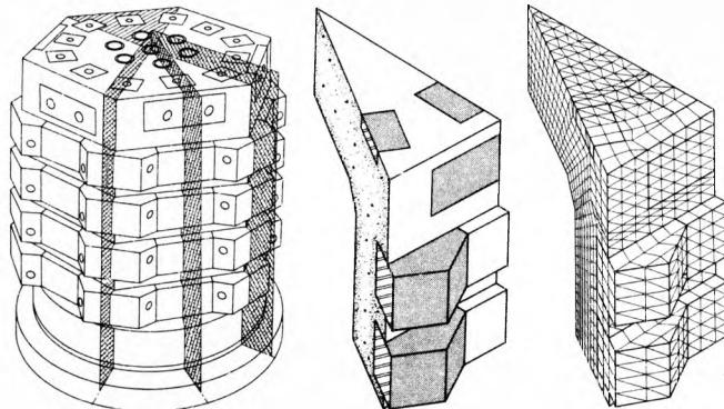
Sl. 16. Proračun nuklearnog reaktora pomoću metode konačnih elemenata. a skica konstrukcije reaktora, b dvanaestina konstrukcije kao jedna simetrična cijelina, c mreža prostornih elemenata u obliku tetraedara i prizmi
