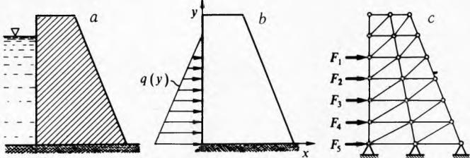
Sl. 1. Određivanje modela konačnih elemenata. a presjek jednostavne brane, b mehanički model kontinuiranim opterećenjem vode  $q(y)$ , gdje je brana predložena kao uklješteni konzolni nosač, c model konačnih elemenata gdje je nosač podijeljen u trokutne elemente, opterećenje raspodijeljeno u čvorove, a uklještenje zamijenjeno nepomičnim osloncima u čvorovima
