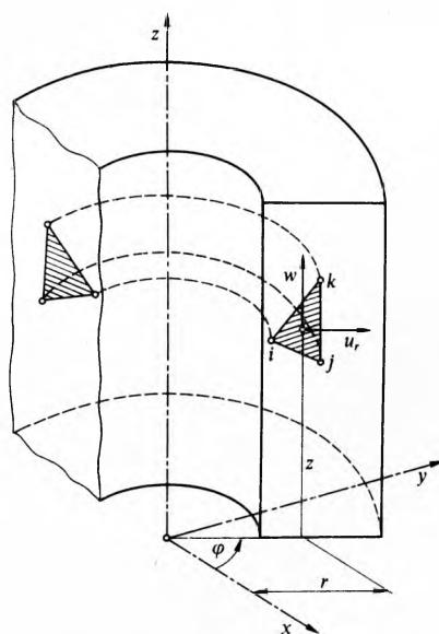
Sl. 19. Rotacijski simetrični element s trokutnim presjekom za osnosimetrične probleme. Pod opterećenjem pomaci su čestica tijela samo u pravcu  $r$  i  $z$  (pomaci  $u_r$  i  $w$ )
