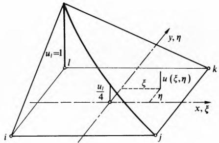
Sl. 10. Raspodjela pomaka  $u$  unutar pravokutnog elementa sa 4 čvora i 8 stupnjeva slobode. Zbog jednostavnosti pretpostavljeno je da je  $u_i = 1$  i  $u_i = u_j = u_k = 0$
