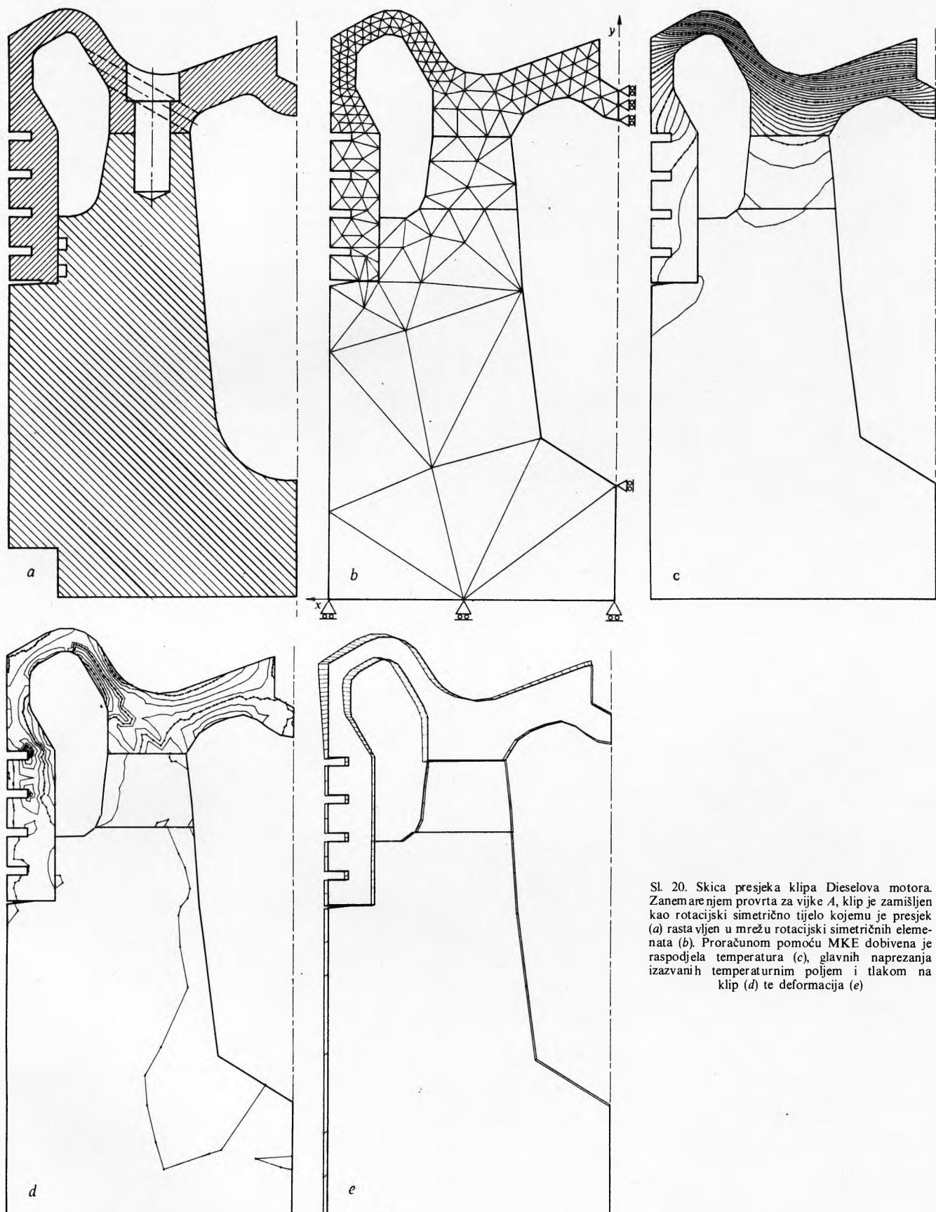
Sl. 20. Skica presjeka klipa Dieselova motora. Zanemarenjem provrta za vijke  $A$ , klip je zamišljen kao rotacijski simetrično tijelo kojemu je presjek (a) rastavljen u mrežu rotacijski simetričnih elemenata (b). Proračunom pomoću MKE dobivena je raspodjela temperature (c), glavnih naprezanja izazvanih temperaturnim poljem i tlakom na klip (d) te deformacija (e)
