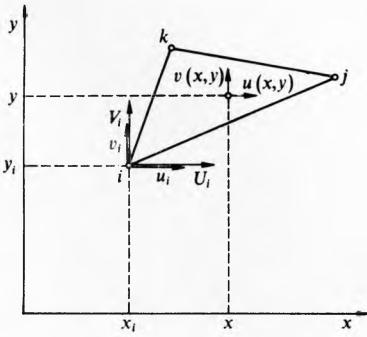
Sl. 5. Trokutni element sa dva stupnja slobode u čvoru najjednostavniji je ravninski element u metodi konačnih elemenata. Pomak svake točke određen je sa dvije komponente  $u$  i  $v$ , a u svakom čvoru djeluju na element komponente sila  $U$  i  $V$
