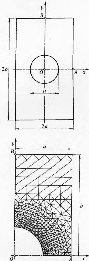
Sl. 3. Mreža trokutnih konačnih elemenata za ploču s otvorom, dobivena automatsiranim podjelom na računalu. Zbog geometrijske simetrije dovoljno je pri simetričnim opterećenjima promatrati samo četvrtinu ploče
