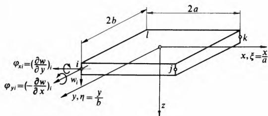
Sl. 21. Pravokutni element za proračun ploča s Descartesovim  $x$ ,  $y$  i bezdimenzijskim koordinatama  $\xi$ ,  $\eta$ . Komponente vektora  $\delta_i$  pomaka u čvoru  $i$  jesu nagibi tangenata na deformiranu ploču  $\varphi_{xi}$  i  $\varphi_{yi}$  prema osima  $y$  i  $x$ , te pomak ploče  $w_i$  u pravcu osi  $z$
