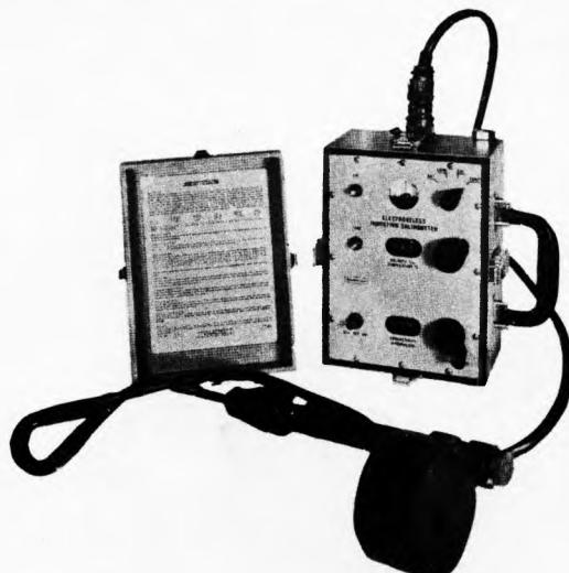
Sl. 28. Indukcijski salinometar za izravno mjerjenje
