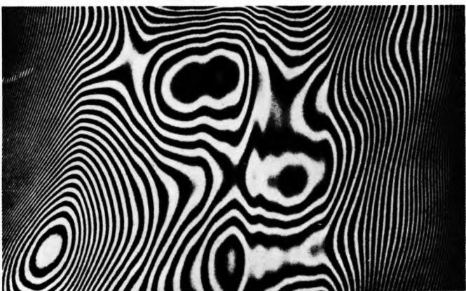
Sl. 69. Fotografija pruga interferencije (pozitiv) jednake debljine nastalih praznim svjetlosti kroz tanku prozirnu pločicu nejednolike debljine
