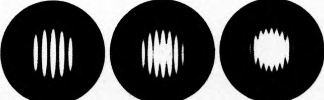
Sl. 58. Snimke pruge interferencije, eksperimentalno dobivenih prema sl. 57, uz djelomično koherentnu svjetlost. Slijeva nadesno su snimke uz povećani razmak  $d$  između točkastih izvora (usporedi sa sl. 62b)
