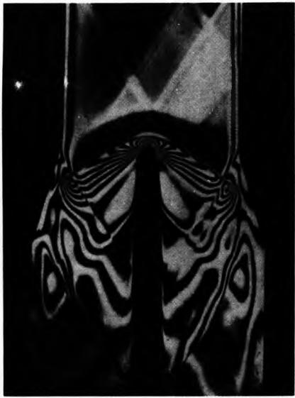
Sl. 77. Fotografija (pozitiv) figure interferencije snimljena Machovim interferometrom. Interferencije su uzrokovane strujanjem zraka nadzvučnom brzinom kojim udara u zaprek.
