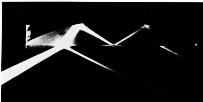
Sl. 9. Fotografija (pozitiv) višestruke totalne refleksije svjetlosnog snopa u plankonveksnoj leći
