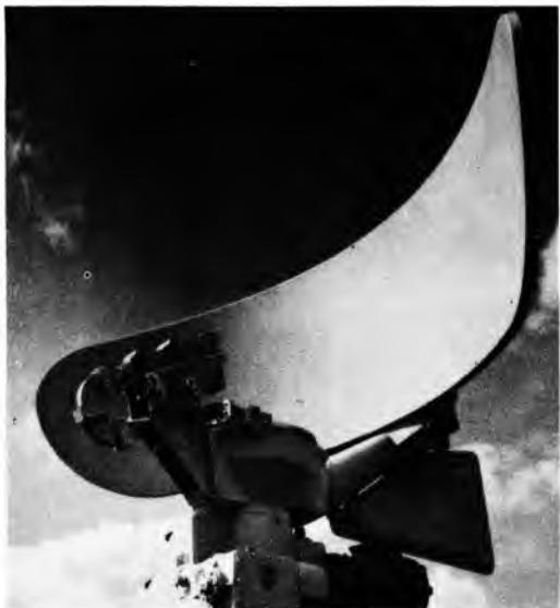
Sl. 58. Antena brodskog osmatračkog radara za otkrivanje ciljeva na morskoj površini i zračnih ciljeva koji lete nisko
