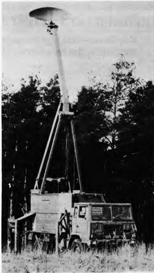
Sl. 49. Taktički osmatrački radar s antenom na podiznom jarbolu
