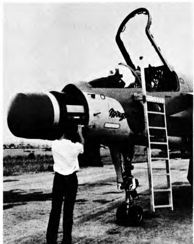
Sl. 55. Antena osmatračkog radara ugrađena u nos aviona Mirage 2000
