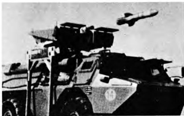
Sl. 12. Vozilo s protuoklopnim raketnim sistemom HOT
