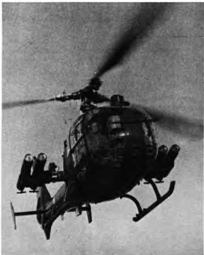
Sl. 27. Helikopter s protuoklopnim raketnim sistemom HOT
