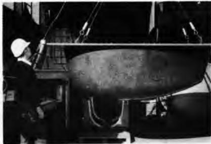
Sl. 62. Strujni plastični plašt čvrste antene sonara ispod kobilice broda
