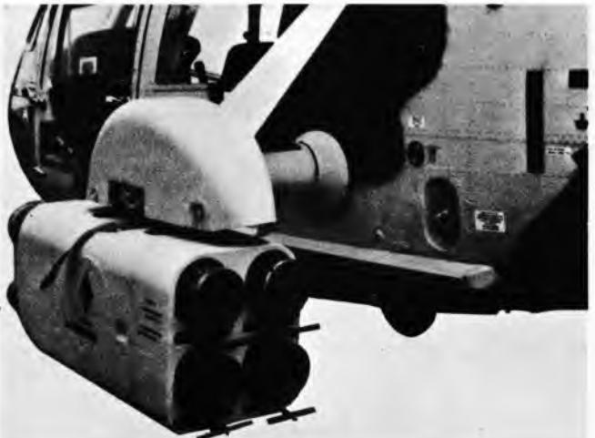
Sl. 28. Kontejner sa 4 protuoklopne rakete sistema HOT
