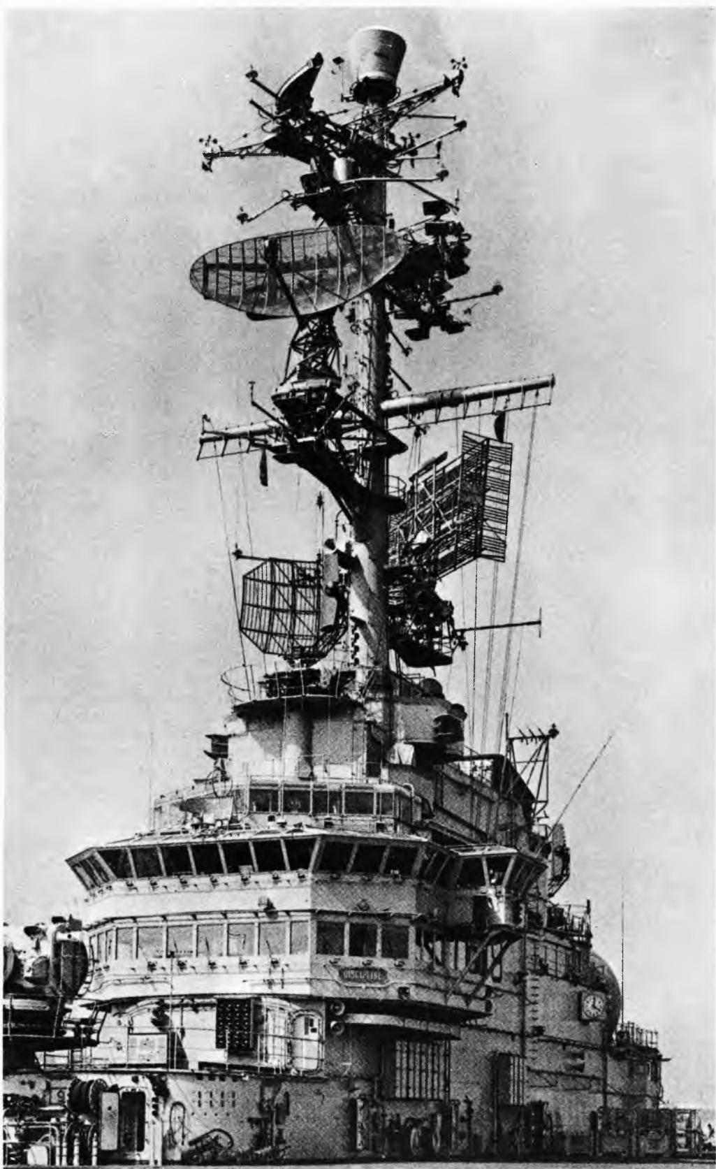
Sl. 57. Jarbol nosača aviona s radarskim antenama. Na vrhu je jarbola antena pasivnoga radarskog analizatora
