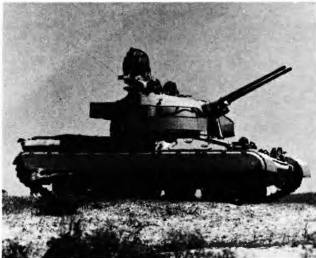
Sl. 16. Samohodni protuzračni artiljerijski sistem s dvocijevnim topom kalibra 30 mm
