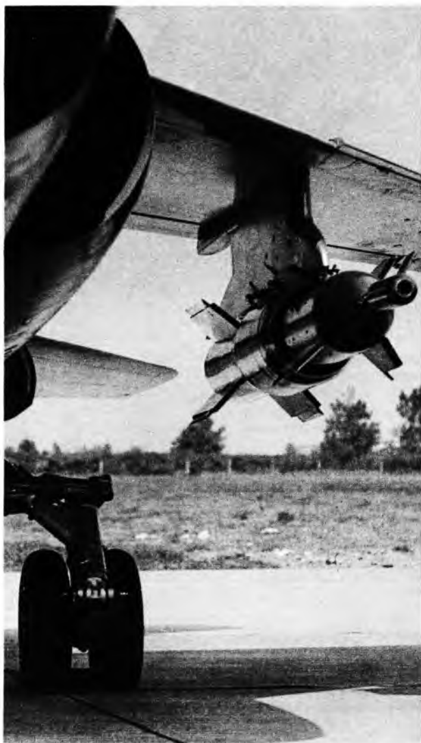
Sl. 26. Klasična padajuća avionska bomba pretvorena u vođenu bombu dodatkom laserske glave za pasivno navođenje i upravljivih kormilnih površina
