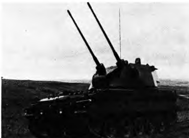
Sl. 9. Samohodni dvocijevni protuavionski top kalibra 30 mm
