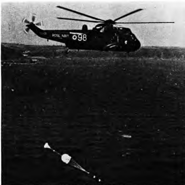
Sl. 32. Lansiranje lakog torpeda sa protupodmorničkog helikoptera
