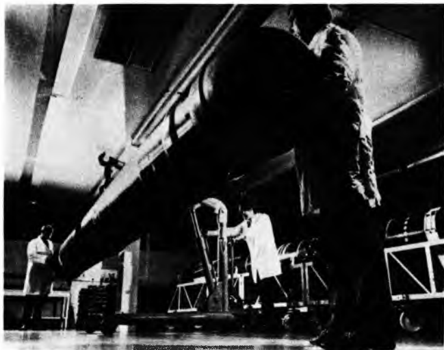
Sl. 31. Teški protupodmornički torpedo kalibra 533 mm
