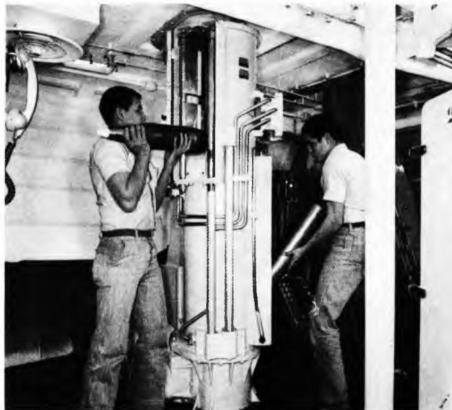
Sl. 12. Posluživanje donje municijske dizalice dvodijelnim mecima kalibra 127 mm (za top na sl. 10)
