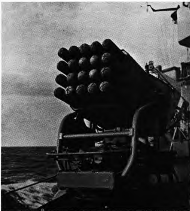
Sl. 71. Brodski višecijevni okretljivi lanser raketa za obmanjivanje
