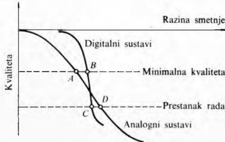
Sl. 12. Primjer prikaza smetnji na analognim i digitalnim uređajima prema razini smetnji
