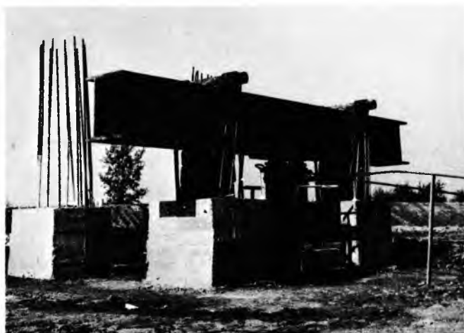
Sl. 36. Pokusno opterećenje tlačnog bušenog pilota pomoću vlačnih pilota na gradilištu termoelektrane Sisak (izvodač Geotekhnika, Zagreb)
