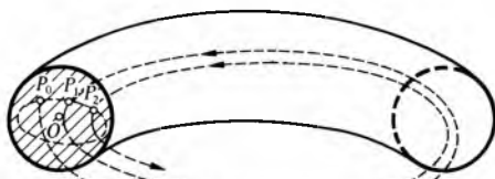
Sl. 14. Magnetno polje sa rotacionom transformacijom
