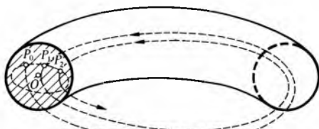
Sl. 14. Magnetno polje sa rotacionom transformacijom
