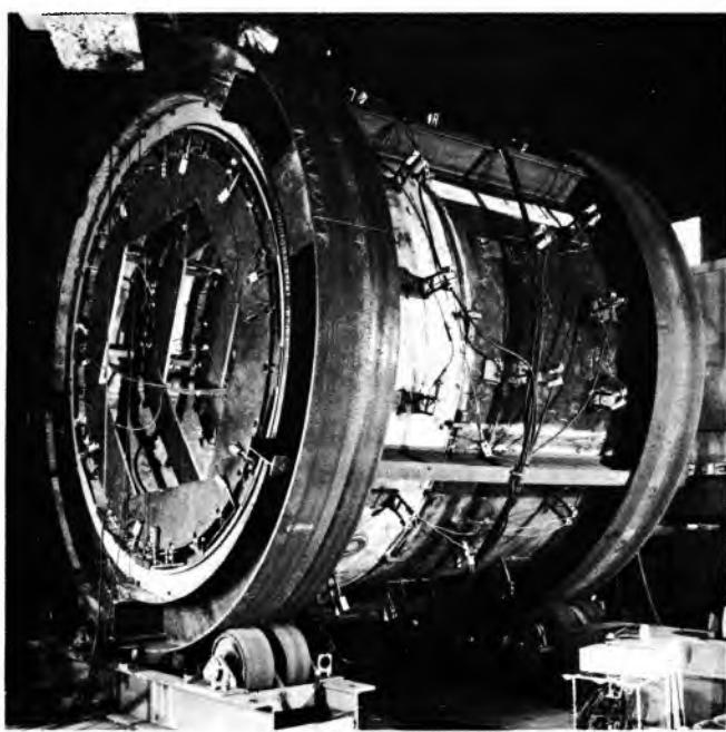
Sl. 69. Izrada prstenaste sekcije manje podmornice uz elektrotoporno zagrijavanje područja spojeva i daljinsko mjerjenje temperature
