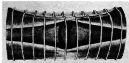
Sl. 16. Deformacija čvrstog trupa podmornice zbog opće nestabilnosti konstrukcije
