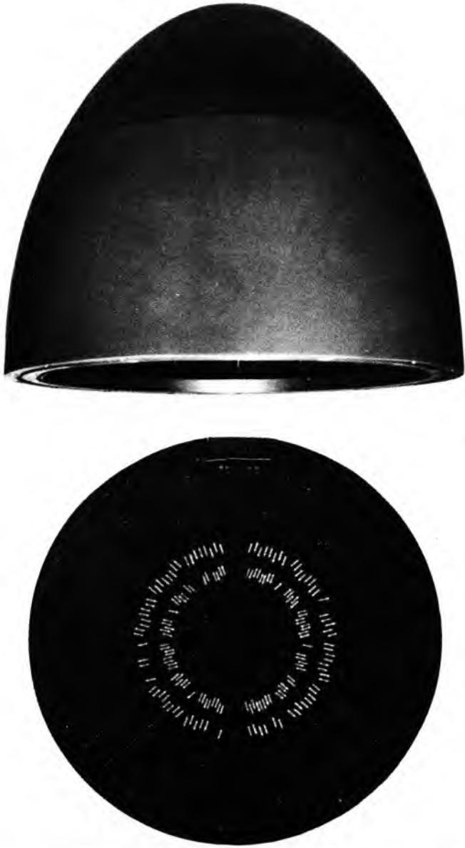
Sl. 46. Glava za samonavodenje torpeda. a plašt glave s kapom od materijala koji propušta zvuk, b elektronički sklopovi sonara u glavi torpeda
