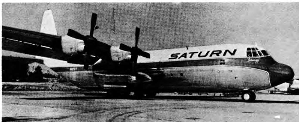
Sl. 47. Veliki transportni avion Lockheed L 100-30 Hercules sa četiri turboelisna propulzora Allison T56, svaki snage 3 652 kW
