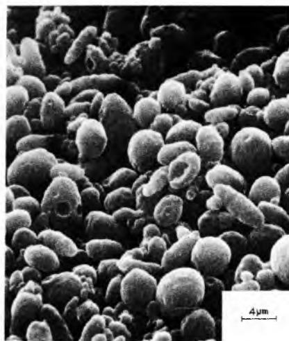
Sl. 12. Čestice elastomera u polistirenu visoke žilavosti snimljene elektronskim mikroskopom
