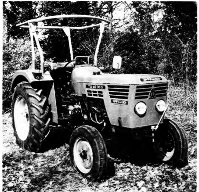
Sl. 1. Univerzalni traktor sa pogonom na zadnjim točkovima. Pogonski dizel-motor hlađen vazduhom, tri cilindra, snaga 33 kW, proizvod fabrike Torpedo, Rijeka
