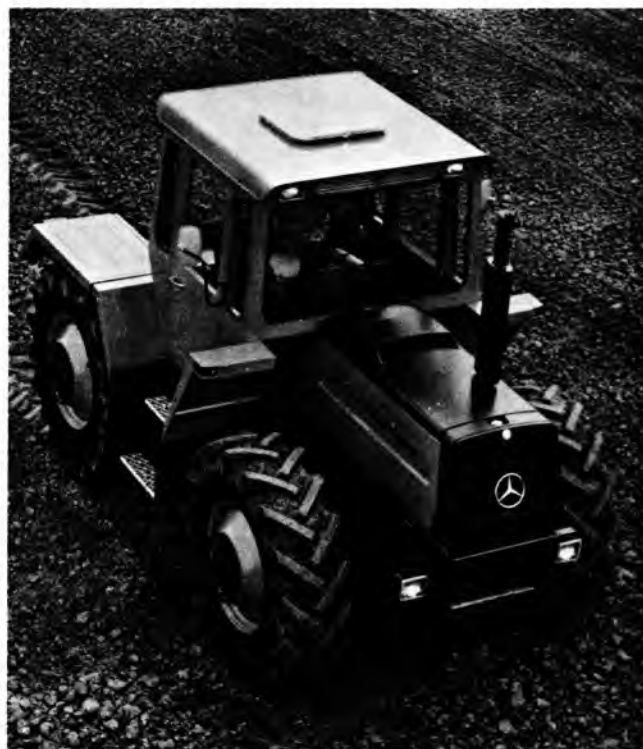
Sl. 2. Sistemski traktor sa pogonom na sva četiri točka. Pogonski dizel-motor sa nabijanjem, hlađen vodom, šest cilindara, snaga 92 kW, proizvod fabrike Daimler-Benz
