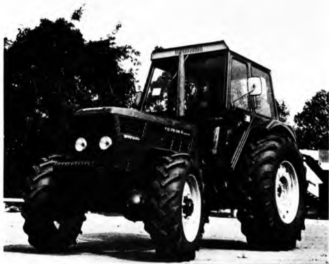
Sl. 4. Specijalni traktor sa pogonom na sva četiri točka. Pogonski dizel-motor hlađen vazduhom, četiri cilindra, snaga 55 kW, proizvod fabrike Torpedo, Rijeka
