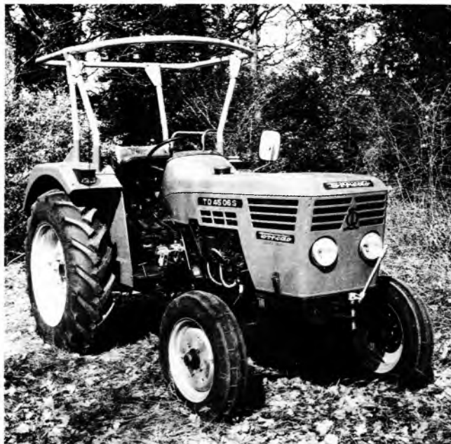
Sl. 1. Univerzalni traktor sa pogonom na zadnjim točkovima. Pogonski dizel-motor hlađen vazduhom, tri cilindra, snaga 33 kW, proizvod fabrike Torpedo, Rijeka
