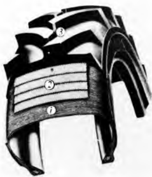
Sl. 19. Radijalni traktorski pneumatik. 1 radijalne niti platna, 2 pojasna platna, 3 rebra
