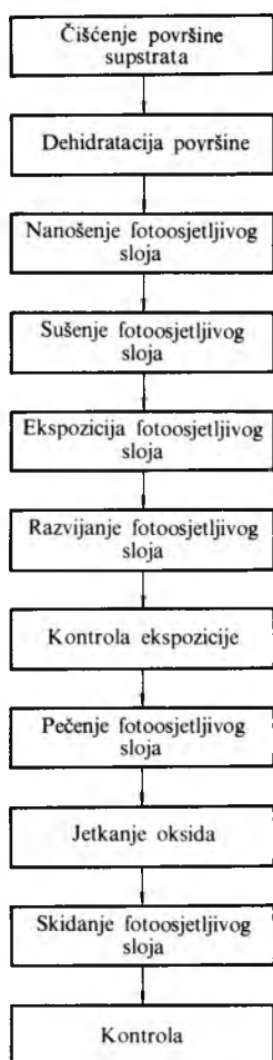
Sl. 18. Shema toka fotolitografskog postupka
