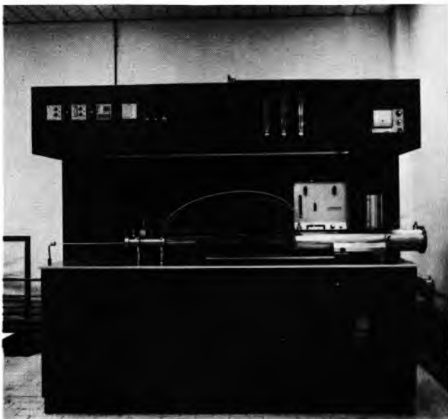
Sl.21. Reaktor za višeslojnu heteroepitaksiju
