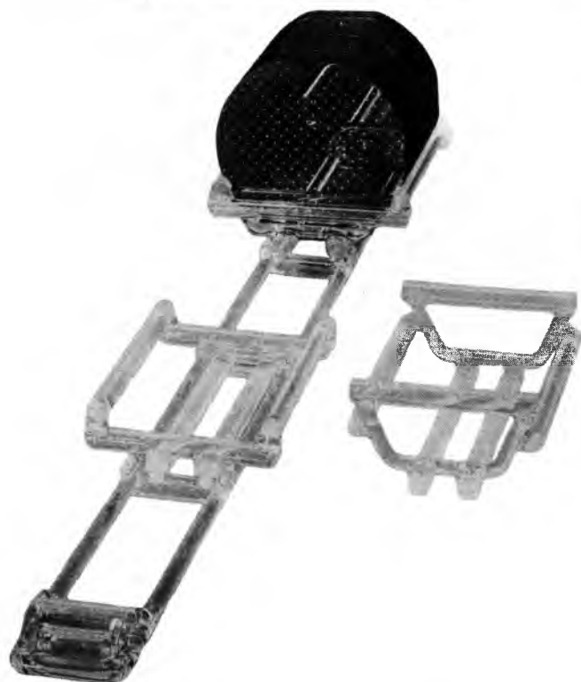
Sl. 10. Kremene ladice za smještaj silicijskih pločica u peći za oksidaciju
