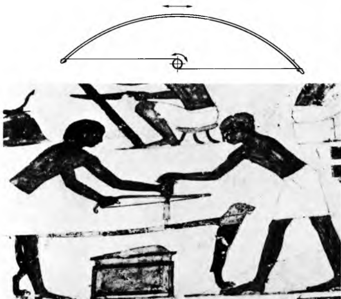
Sl. 3. Bušenje pomoću luka kojim se pravocrtno gibanje pretvara u kružno (oko \leftarrow 1450 . god.)
