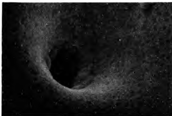
Sl. 89. Provrt promjera 0,25 \mu\text{m} izrađen laserom i naknadno smanjen pozlaćivanjem
