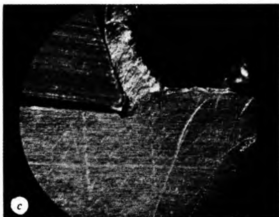
Sl. 14. Vrsta strugotine. a trgana strugotina, b tekuća strugotina, c tekuća strugotina s naljepkom
