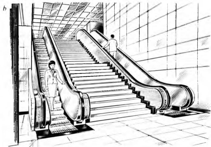
Sl. 125. Eskalator. a shematski prikaz. b generalni pogled; 1 stube pričvršćene za lanac, 2 lanac, 3 pokretni rukohvat, 4 pogonski užetnik za rukohvat, 5 pogonsko postrojenje, 6 naponski uređaj za rukohvat
