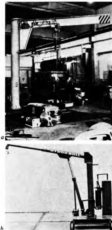
Sl. 18. Okretni stupni granici. a) okretni stupni granik opće primjene, b) okretni stupni granik za izmjenu alata i materijala na alatnim strojevima
