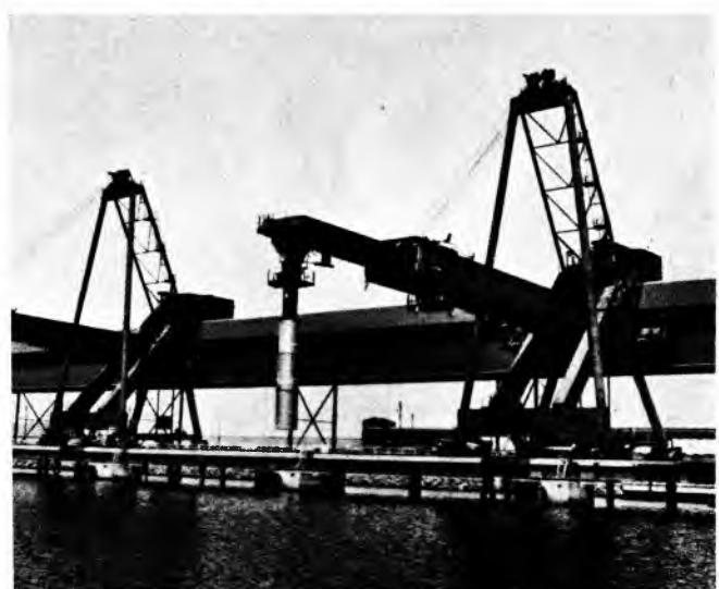
Sl. 36. Brodski utovarivač s teleskopskim trakastim transporterom u izložniku za utovar kamenog ugljena. Kapacitet je jednog utovarivača 2250 t/h (PHB)
