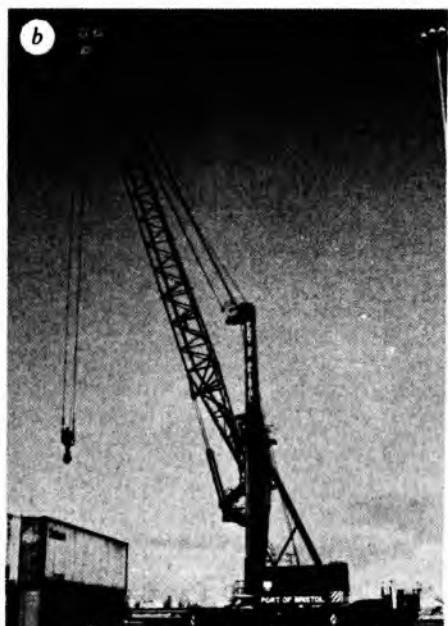
Sl. 51. Cestovni granici s rešetkastim dohvavatnikom (GOTTWALD, Düsseldorf). a cestovni granik s dohvavatnikom za visokogradnje nosivosti 80/90 t, b cestovni lučki granik nosivosti 40 t uz doseg 28 m (24 t uz doseg 40 m) u luci Bristol na pretovaru kontejnera
