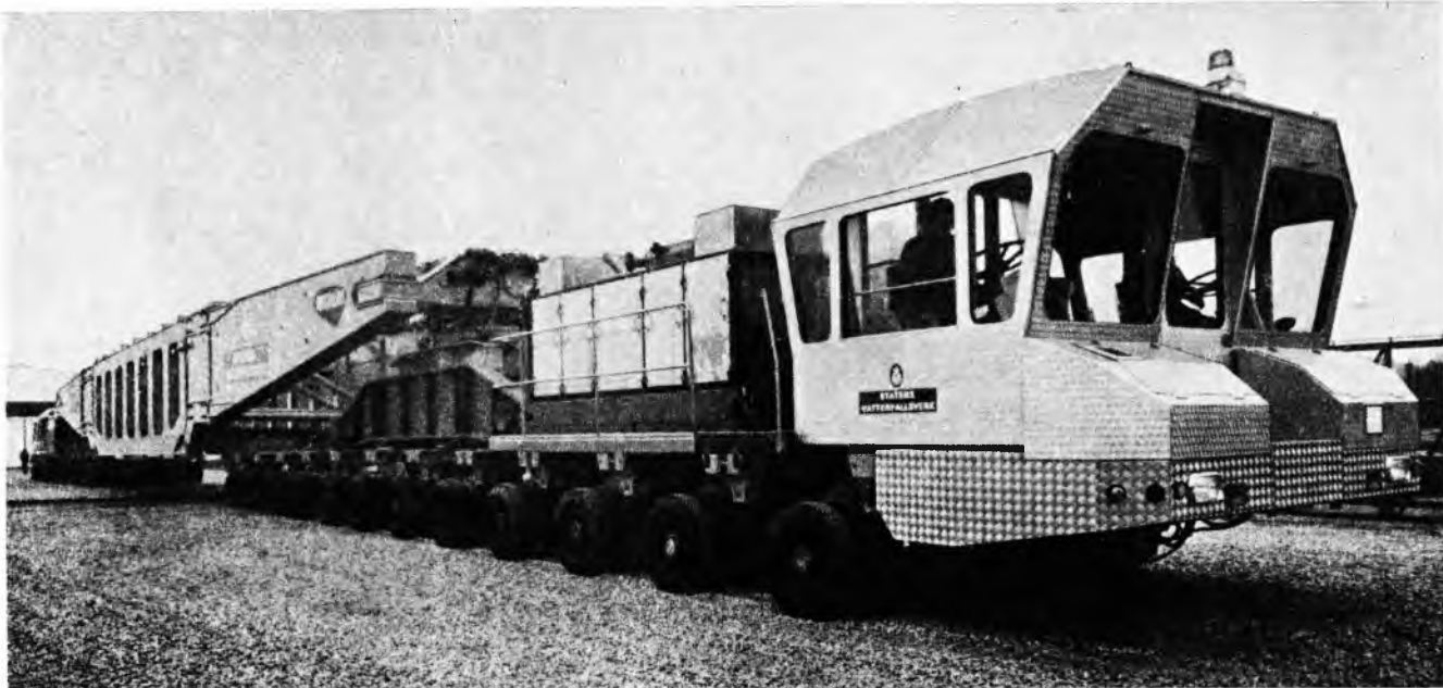
Sl. 142. Specijalno cestovno vozilo s vlastitim pogonom za prijenos teških tereta (Nicolas, Champs-sur-Yonne)
