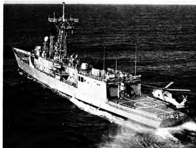
Sl. 13. Gubitak velikog dijela površine na otvorenoj palubi uvodenjem helikoptera
