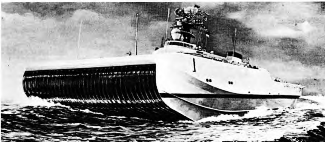
Sl. 21. Projekt raketnog broda s dinamičkim učinkom površine (SES)
