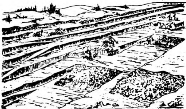
Sl. 53. Pogled na površinski kop s eksploatacijom s poprečnim blokovima
