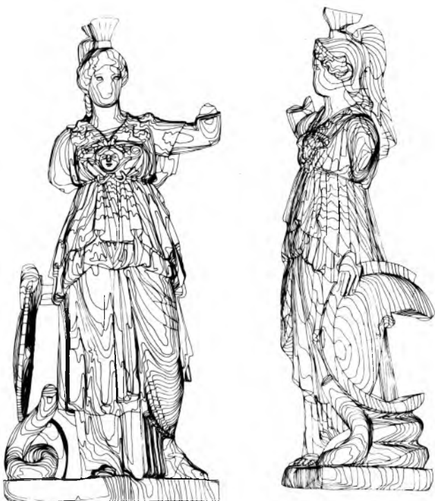
Sl. 6. Ortogonalna projekcija Minervina kipa iz Varaždinskih Toplica (fotogrametrijska obradba Zavoda za katastar i geodetske poslove grada Zagreba)
