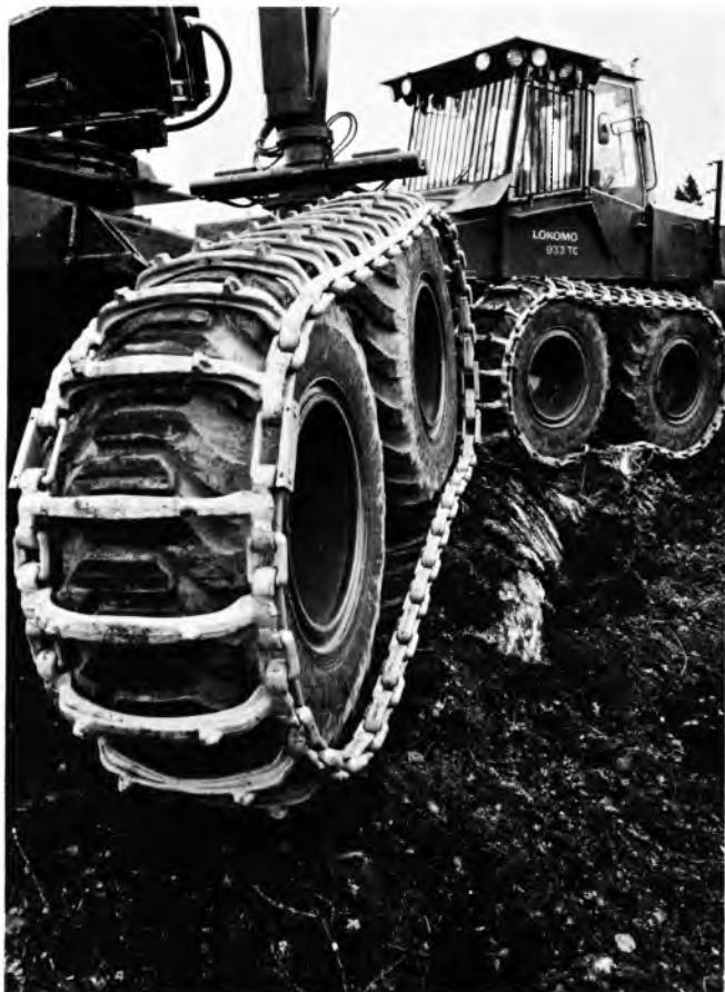
Sl. 33. Primjer svladavanja terenskih prepreka vozilom s dva bogie-sustava
