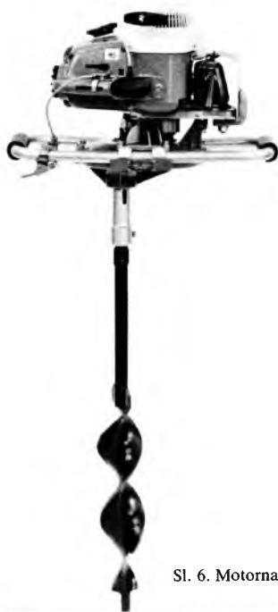
Sl. 6. Motorna bušilica priključena na motor lančanice
