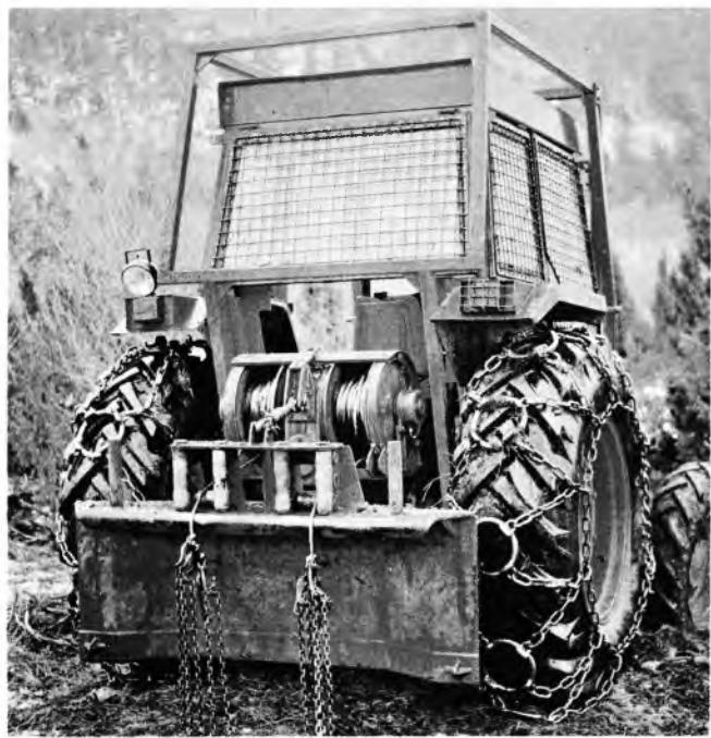
Sl. 45. Primjer ugradnje dvobubanjskog vitla na traktor
