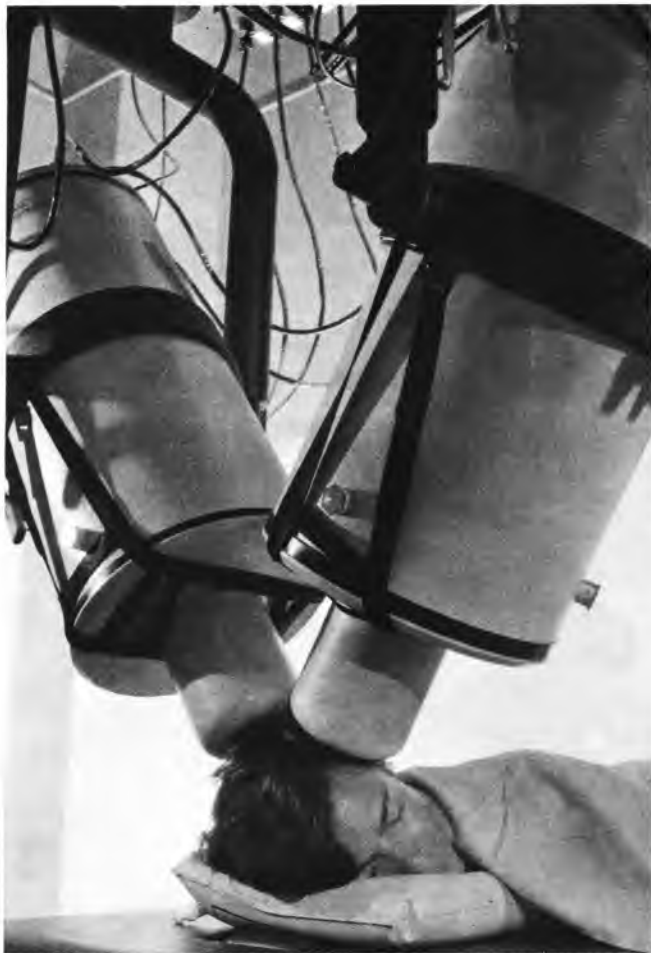
Sl. 18. Uređaj za magnetsku encefalografiju s dvije kvantnointerferentne naprave za mjerenje magnetskog polja sa supravodičima s ukapljenim helijem
