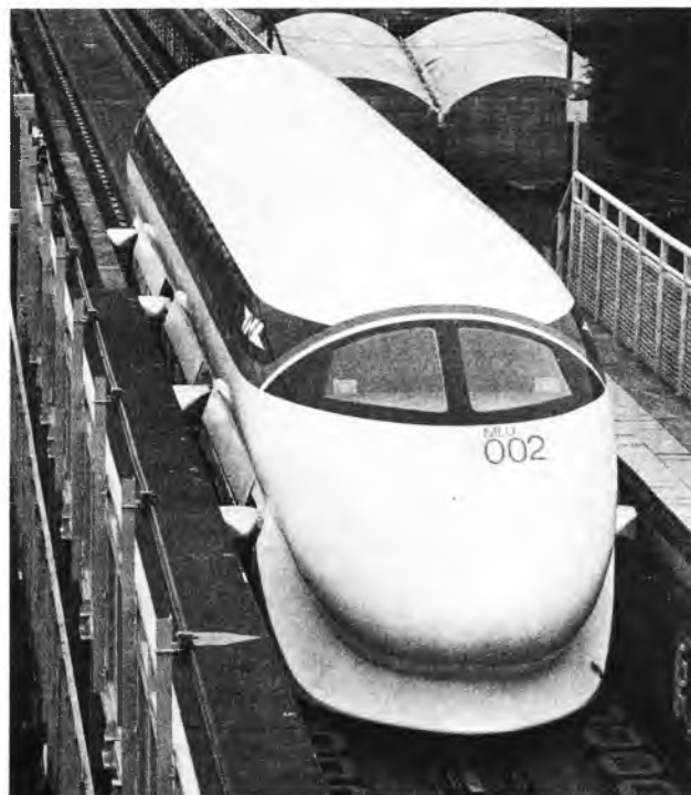
Sl. 17. Japanski prototip (MLU-002) magnetski lebdećeg vozila projektiranog za brzinu do 500 km/h
