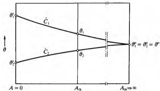
Sl. 58. Promjena temperature u istosmjernom izmjenjivaču topline s povećanom površinom
