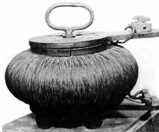
Sl. 1. Prvi transformator sa zatvorenim željeznom jezgrom
