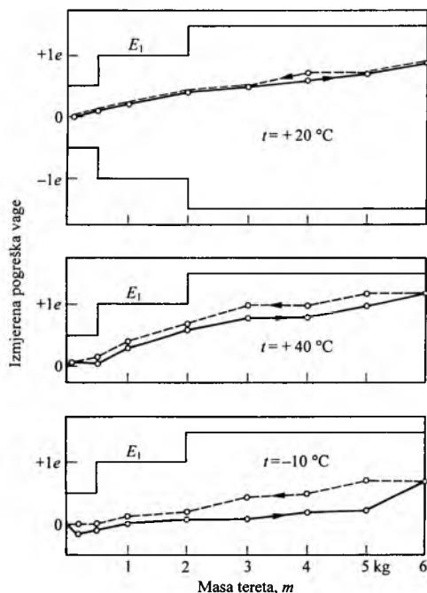
Sl. 53. Ovisnost pogreške trgovачke stolne vase nosivosti 6 kg pri temperaturama  $+20^{\circ}\text{C}$ ,  $+40^{\circ}\text{C}$  i  $-10^{\circ}\text{C}$
