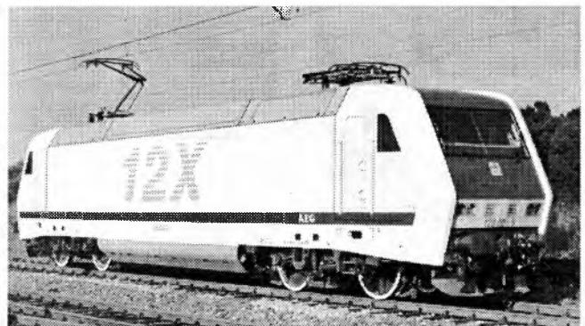
Sl. 33. Univerzalna lokomotiva 12X (AEG, proizvodnja 1994) za tešku teretu vuču i brze putničke vlakove (trajna snaga 6 400 kW, vučna sila pokretanja 300 kN, masa 84 t, duljina 19 500 mm, 4 pogonske osovine, brzina 220 km/h, napajanje strujom od 15 kV/16 $\frac{2}{3}$  Hz).
